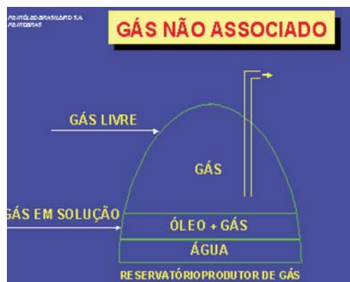
Fig. 2 - Reservatório produtor de gás não-associado.
