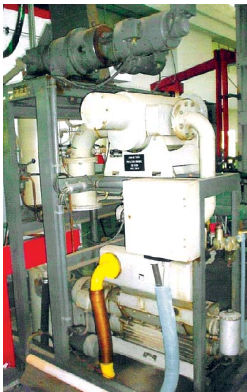
Figura 2 – Forno de fusão para obtenção de lingotes de Ti. Fonte: CTA
