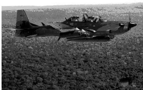
O AT27 tem a possibilidade de ser equipado com bombas e/ou foguetes, e/ou dois “pod” de metralhadora, e/ou dois
