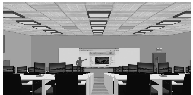
Figura 6: Proposta de disposição da sala de aula, visão do fundo para frente, com os detalhes das luzes fluorescentes, dos resfriadores evaporativos no teto e do forro acústico do teto.
