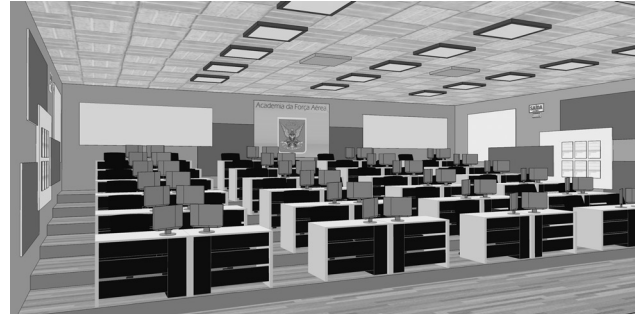
Figura 4: Proposta de disposição da sala de aula, visão da frente para os fundos, com os detalhes do piso, da iluminação, dos exaustores evaporativos, do mobiliário, dos computadores, do quadro de avisos, das luzes de segurança e da decoração.
