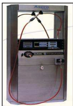
Fig. 5 - Unidade abastecedora de GNV.
