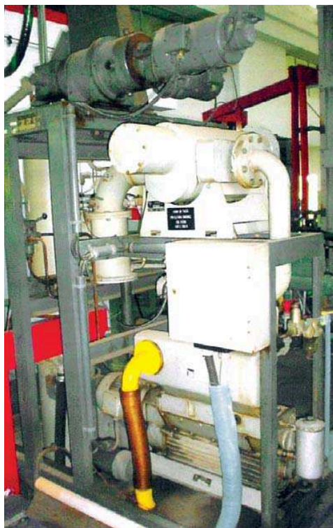
Figura 2 – Forno de fusão para obtenção de lingotes de Ti.
