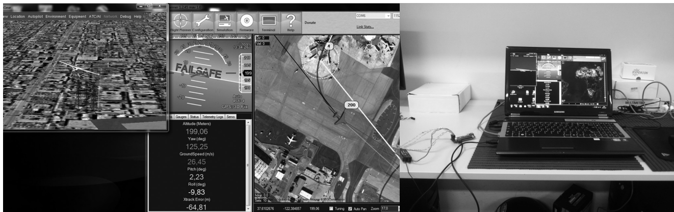
Figura 6: Experimentos de “Hardware-in-the-loop”, com o Ararinha, utilizando o software aberto e hardware Arduino e simuladores de voo.
